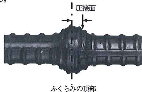
写真4.4 圧接面のずれ
