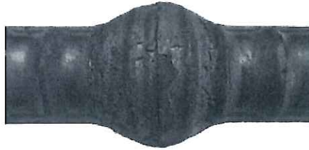
写真4.12 圧接面のすじ
