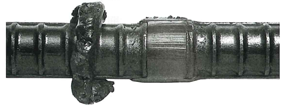
写真4.6 良好な表面外観 (表面さずなし)
