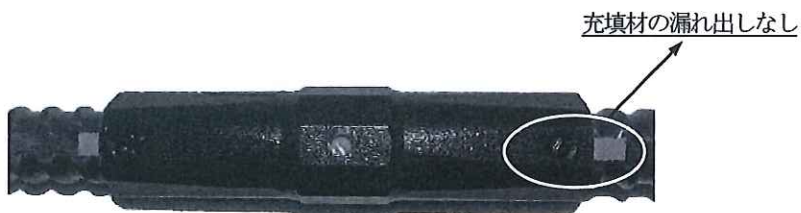
(d) グラウト材の充填不足：不合格
